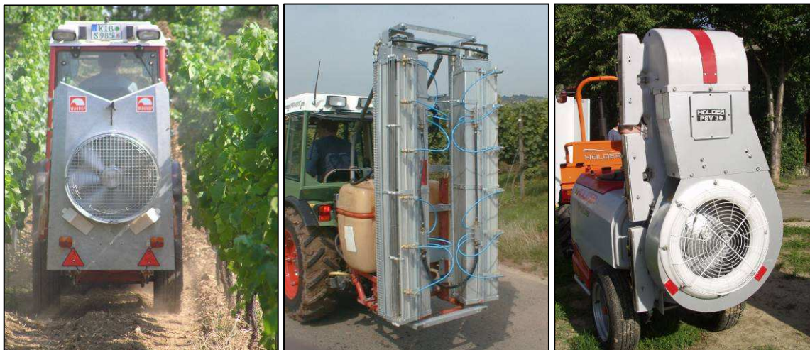
Abbildung 64: Axialgebläse mit Luftleitsystem (links), Tangentialgebläse (Mitte), Diffusor-Radialgebläse (rechts)
